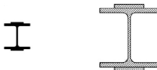
Figura 41. Paraqitja grafike e prerjes së profileve metalike sipas përpjesës së vizatimit
